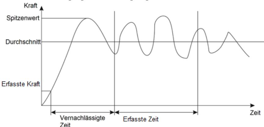
**MOD2:** Bei dieser Funktion wird der Durchschnitt oberhalb des eingestellten kleinsten Messwertes errechnet. Fällt der Messwert wieder unter den eingestellten kleinsten Messwert, ist die Messung beendet. Dieses Messverfahren ist über einen Zeitraum von 10 Minuten möglich.
