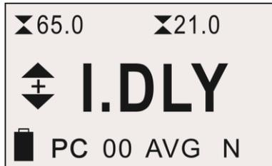
Liegt die Mindestlast an und ist die Mindestzeit abgelaufen, beginnt die eigentliche Messung. Auf dem Display erscheint „GATHER“. Die Messung wird durchgeführt. Während dieser Messung ist es nicht möglich, den aktuell anliegenden Messwert zu sehen.
