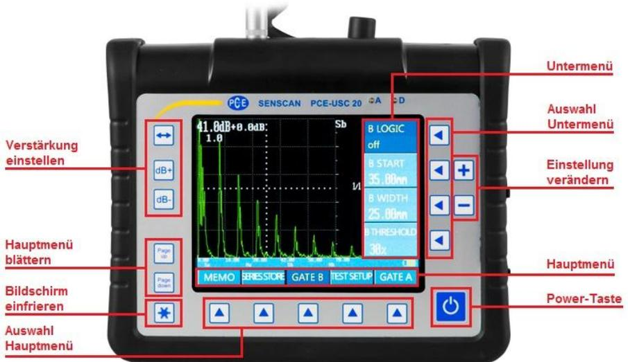
Abb. 1 Übersicht Funktionstasten Prüfgerät PCE-USC 20
