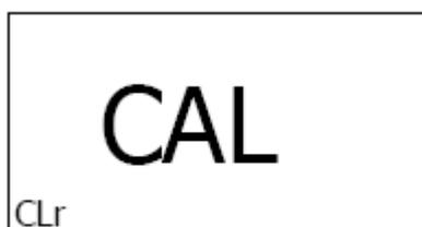
Das Display wird nach kurzer Zeit wieder zurück in den Messmodus springen. Das Gerät hat nun den Löschvorgang beendet und alle Kalibrierpunkte gelöscht.
