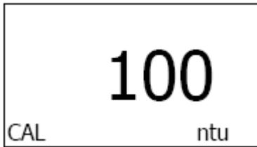
Die 0 NTU Kalibrierung ist nun abgeschlossen und mit der 100 NTU Kalibrierung kann nun begonnen werden.
