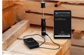
Abbildung 3 PCE-WMT 200 mit Messelektrode
