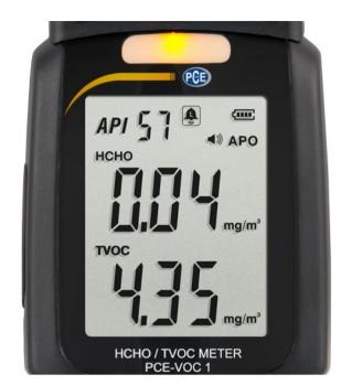
Gasmessgerät Formaldehyd PCE-VOC 1
