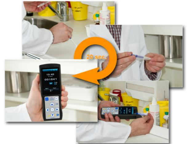
**ATP Messgerät PCE-ATP 1 / schnelle Hygienemessung / einfachste Probennahme / USB und BluetoothSchnittstelle / Selbstkalibrierung beim Einschalten /**
