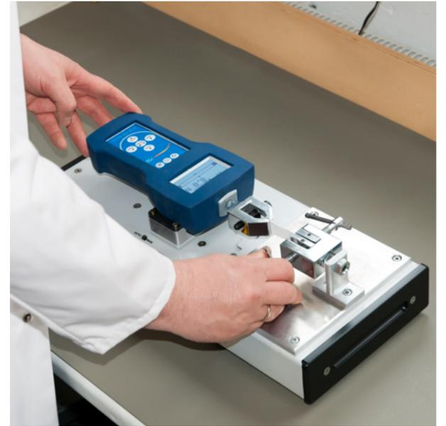
**Prüfgerät für Zug und Druckversuche/ mobile, robuste Bauform / bis 500 N / hohe Genauigkeit / PC-Auswertung möglich**
