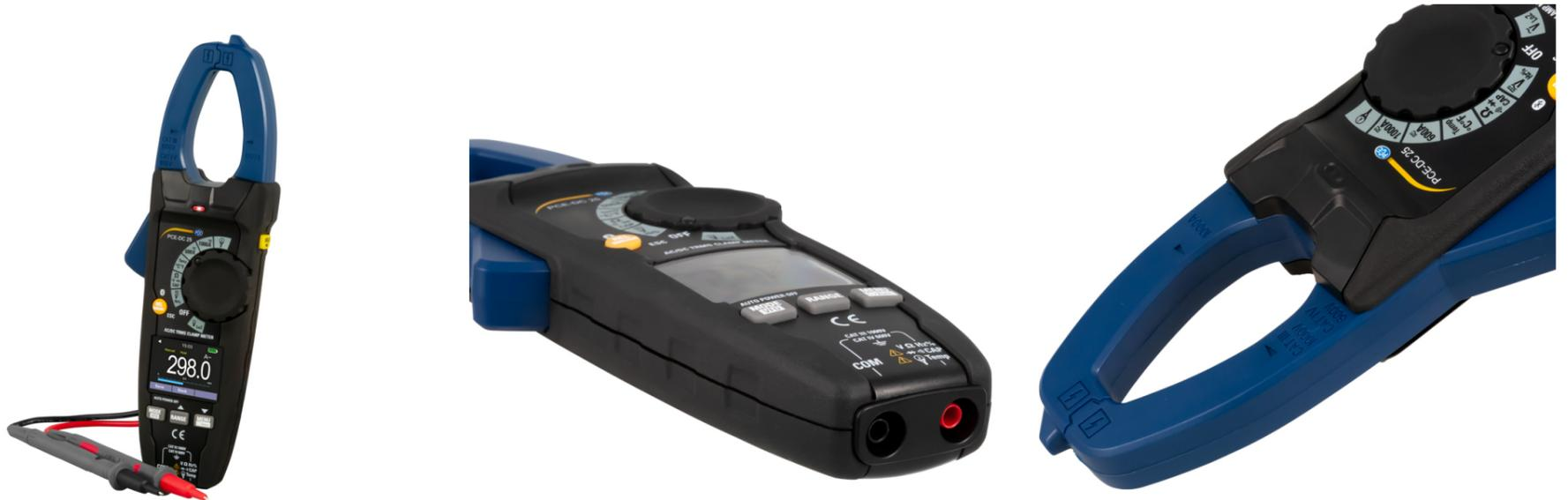
**Amperemeter** mit Bluetooth Schnittstelle / Strommessung 0 ... 1000 A AC/DC / Temperaturmessung / NCV Prüfung / Zangenöffnung 34 mm / Messrate von 3 Hz / optional mit Rogowski Spule für 3000 A AC erweiterbar / automatische Abschaltung
