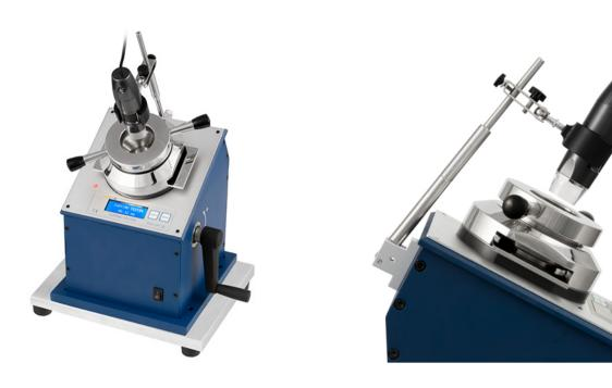
Haftfestigkeitsprüfgerät PCE-CPT 20 (DIN ISO 1520) / Lieferung mit Leuchtlupe / Prüfung von Haftfestigkeit und Dehnungsfähigkeit von Beschichtungen / Prüfblechdicke 0,3 mm ... 1,25 mm / Auflösung 0,01 mm
