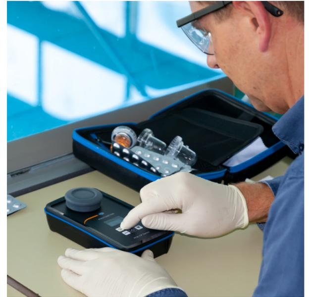
**Multi-Parameter-Photometer mit Bluetooth Schnittstelle / PC-Software / Cloud Service / Systemübergreifende Synchronisation der Messwerte / bis zu 13 auswählbare Parameter / zur Messung von zum Beispiel pH, Alkalinität, Chlor, Cyanursäure / Messwertspeicherung**
