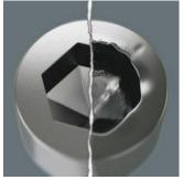
Innensechskantschrauben sind problematisch, die denn Anlageflächen, über die die Kraft vom Werkzeug auf die Schraube übertragen wird, sind sehr schmal. Die Folge: Der Schraubenkopf kann zerstört werden. Hex-Plus größere Werkzeuge haben Anlageflächen, die diese Gefahr verringern. Gut zu wissen: Hex-Plus Werkzeuge passen in jede Sta ndard-Innensechskantschraube!
