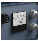
Die Stückprüfung bei 10.000 Volt gemäß IEC 60900 garantiert sicheres Arbeiten unter Spannung bis 1.000 Volt.
