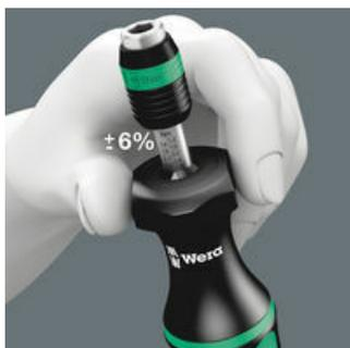
Messgenauigkeit  $\pm 6\%$  (Artikel 1430:  $\pm 10\%$ ) nach Norm DIN EN ISO 6789. Deutlich hör- und spürbares Übrerrasten beim Erreichen des eingestellten Drehmoments.
