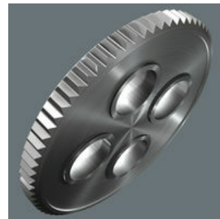
Feinzahnmechanik mit 60 Zähnen ermöglicht einen kleinen Rückholwinkel von 6° für präzises Arbeiten.
