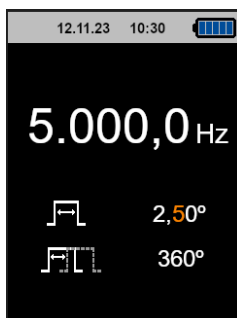
Abb. 6. Schnellmodus – Änderung Tastverhältnis
