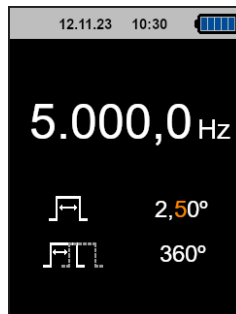
Abb. 6. Schnellmodus – Änderung Tastverhältnis
