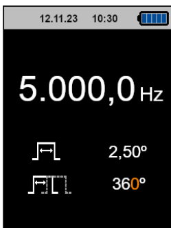
Abb. 7. Schnellmodus – Änderung Phasenverschiebung
