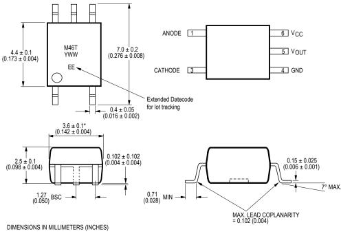
\* MAXIMUM MOLD FLASH ON EACH SIDE IS 0.15 mm (0.006)
