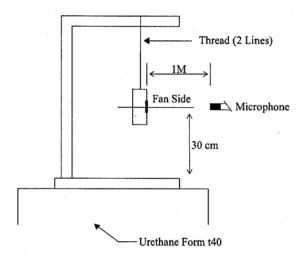
1 METER FROM MICROPHONE TO FAN INTAKE
