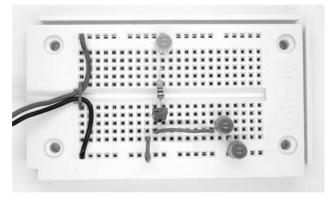
Fig. 45: The light sensor (Aufbau17.jpg)
