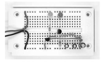
Fig. 51: The soft flasher (Aufbau20.jpg)
