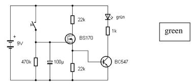
Fig. 48: Slow capacitor discharge (Schaltung19.jpg)
