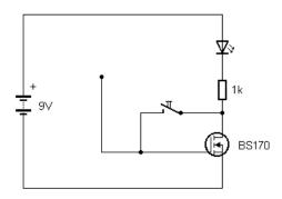
Fig. 42: The electrometer (Schaltung16.jpg)
