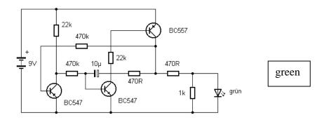
Fig. 36: The flashing light circuit (Schaltung13.jpg)
