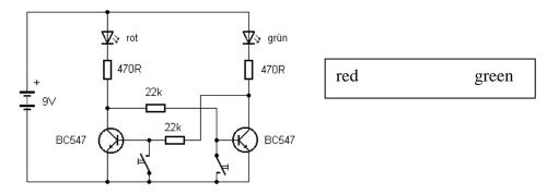
Fig. 28: A bistable flip-flop (Schaltung9.jpg)
