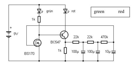
Fig. 50: A phase shifter oscillator (Schaltung20.jpg)
