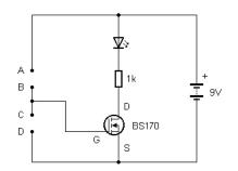
Fig. 38: Basic MOSFET circuit (Schaltung14.jpg)
