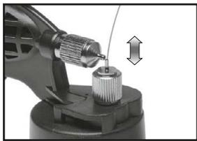
**18.** Zwischendurch sollte die Farbdüse mit einem feinen Draht (nicht enthalten) gereinigt werden. Clean the paint nozzle at regular intervals with a fine wire (not included). De temps à autre, il est recommandé de nettoyer la buse de jet de couleur avec un fil métallique fin (non compris). De verfspuiter moet tussendoor met een fijne draad (niet inbegrepen) worden gereinigt.
