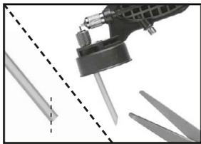
**8.** Saugrohr der Pistole wenig schräg abschneiden. Cut the airbrush's suction tube slightly slanted. Couper un peu en biais le tuyau d'aspiration de l'aérographe. Zuigbuis van de verfspuit schuin afknippen.
