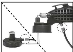
**5.** Luftschlauch an den Regler und die Spray Gun anschließen. Connect the air hose to the spray gun and the regulator. Raccorder le tuyau à air au régulateur et à l'aérographe. Lucht slang aan de regelaar en de verfspuit sluiten.
