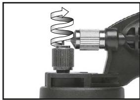
**11.** Farbdüse der Pistole in „Sprühposition“ drehen. Turn the paint nozzle of the airbrush to "spray position". Tournier la buse à peinture de l'aérographe en position « pulvérisation ». Verfspuiter van de verfspuit in „sproei-positie“ draaien.
