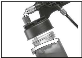
**10.** Das gefüllte Farbglas unter die Spritzpistole schrauben. Screw the filled paint jar underneath the airbrush. Visser le flacon de peinture rempli sous l'aérographe. Schroef het gevulde verpotje onder de verfspuit.
