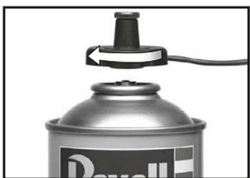
**4.** Treibmittelregler auf die Airbrush Power Dose schrauben. Screw the propellant regulator onto the Airbrush Power can. Visser le régulateur de gaz sur la bombe à gaz Airbrush Power. Drijfgas regelaar op de Airbrush Power bus schroeven.
