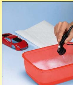
Nichts ist wichtiger als eine sorgfältige Reinigung der Spritzpistole: Farbglas abschrauben. Farbreste auf Küchenkrepp aussprühen. Pistole so in eine Schüssel mit Wasser halten, dass das Saugrohr ins Wasser taucht. Sprühen Sie das Wasser-Farb-Gemisch direkt in die Schüssel.
