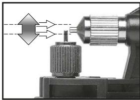
**13.** Nur wenn sich die Spitze der Farbdüse innerhalb dieses Bereiches befindet, kann die Flüssigkeit im Glas angesaugt und versprüht werden. Only when the tip of the paint nozzle is in this position can the liquid be sucked up and sprayed. Le liquide ne pourra être aspiré du flacon et vaporisé que si la pointe de la buse à peinture se trouve à l'intérieur de cette zone. Alleen als de punt van de verfspuit zich in dit bereik bevindt, kan de vloeistof uit het glas worden opgezogen en verstoven.
