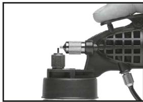
**12.** Dies ist die optimale Sprühposition der Farbdüse. This is the optimum spraying position for the paint nozzle. Voici la position optimale de la buse à peinture pour pulvériser. Dit is de optimale sproei-positie van de verfspuiter.
