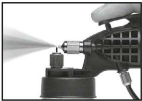
**14.** Bedienungshebel betätigen. Jetzt wird die Flüssigkeit fein zerstäubt. Press the operating lever. Now the liquid emerges as a fine spray. Actionner la gâchette. Le liquide est maintenant pulvérisé en nuage très fin. Hengel bedienen. Nu wordt de vloeistof fijn verstoven.
