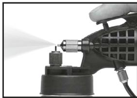
**7.** Bedienungshebel kurz betätigen. Jetzt tritt Druckgas aus der Luftdüse aus. Give the operating lever a quick press. Compressed air is now released from the air nozzle. Actionner brièvement la gâchette. Le gaz sous pression sort maintenant de la buse à air. Regelaar even bedienen. Nu treedt er drukgas uit de bus.
