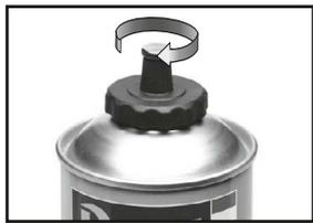
**6.** Druckgas freigeben, indem der Regler gegen den Uhrzeigersinn gedreht wird (ca. 3 - 5 Umdrehungen). Release compressed gas by turning the regulator anti-clockwise (approx. 3 to 5 full turns). Libérer le gaz en tournant le régulateur dans le sens contraire des aiguilles d'une montre (3 à 5 tours env.). Drukgas vrijgeven door de regelaar tegen de wijsers van de klok in te draaien (ca. 3 - 5 omwentelingen).
