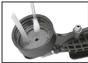
**17.** Pistole zwischendurch und am Arbeitende sorgfältig reinigen (z.B. mit Wat-testäbchen). Clean the spray gun thoroughly during and after any airbrushing job (e.g. with cotton buds). Bien nettoyer l'aérographe de temps en temps et quand le travail est achevé (avec un coton-tige par ex.). Verfspuit tussendoor en na het gebruik goed reinigen (bv. met een wattestaaftje).
