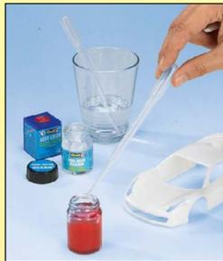
Geben Sie den Inhalt einer Aqua Color Dose (gut aufrühren!) in ein Mischglas. Verdünnen Sie mit 4 ml Wasser/Mix (d.h. ca. 4 Teile Farbe : 1 Teil Wasser/Mix). Testen Sie die Farbmischung. „Spuckt“ die Pistole, obwohl die Farbdüse korrekt eingestellt ist (Punkt 11-15 Rückseite), verdünnen Sie die Farbe noch etwas mehr.
