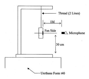
1 METER FROM MICROPHONE TO FAN INTAKE
