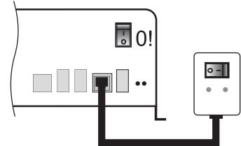
Stecken Sie ein Ende des Anschlusskabels in die Buchse (3) an der Fernbedienung und das andere Ende in die Anschlussbuchse für die Kabel-Fernbedienung FB-01 SWD am Wechselrichter, bis diese hörbar einrasten.
