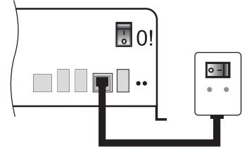
De aansluitkabel is 6-polig en heeft af fabriek een lengte van 4 m. Mocht dit voor uw gebruik niet voldoende zijn, dan kan een langere kabel van max. 10 m worden gebruikt. Het contact maken met de stekker geschiedt 1:1.
