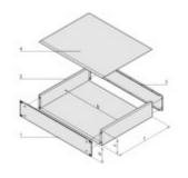
h = lichte Einbauhöhe (H - 30), b = lichte Einbaubreite = 447 mm
