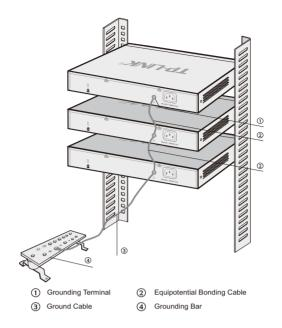
Figure 3-3 Equipotential Bonding
