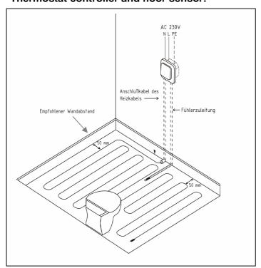
Anschlusskabel des Heizelementes = Connecting cable for heating element
