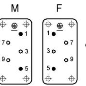
Schaltkontakt mating contact contact de branchement O Arbeitskontakt working contact contact de travail
