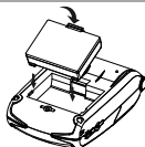
Instalação da Bateria
