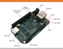
1. 用产品附带的USB线缆分别连接 element14 BeagleBone Black开发板上的P4接口和计算机上的USB接口,以便为其提供电源。
