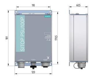
Bild 2: Maßbild Figure 2: Dimensions Figure 2: Dimensions Figura 2: Dimensione Figura 2: plano acotado
