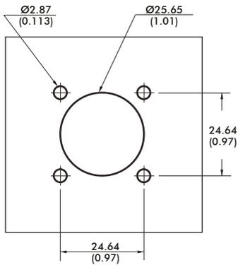
4 x EINPRESSBOLZEN
