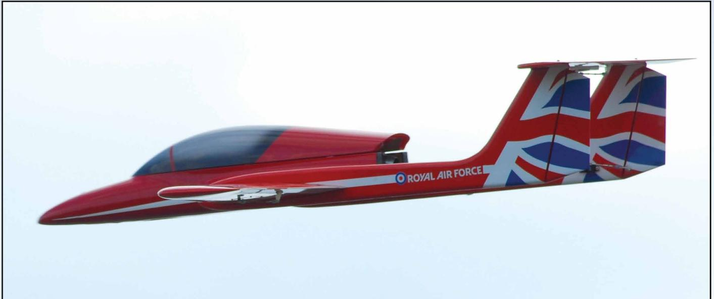
damit das Modell abheben kann. Wir empfehlen Ihnen das Fahrwerk einzufahren, und das Modell auf Flughöhe zu bringen. Nachdem Sie eine komfortable Höhe erreicht haben sollten Sie die Leistung reduzieren, da das Modell sehr schnell Geschwindigkeit aufbauen kann. Normalerweise reicht die Hälfte der Leistung, um die komfortable Reisegeschwindigkeit zu halten.
