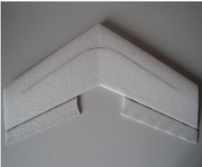
Schneiden Sie anhand der Maßzeichnung einen ca. 5mm tiefen Schlitz für die Carbonstäbe in die Unterseite der Tragfläche. Danach drücken Sie beide Stäbe in den Schlitz und verkleben diese indem Sie Sekundenkleber in den Schlitz laufen lassen.
