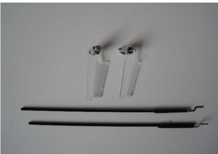
Montieren Sie nun beide Gestänge indem Sie den Z-Draht mit Sekundenkleber und dem Schrumpfschlauch mit dem Gestänge verbinden. Beide Ruderhörner können auch bereits komplett zusammengebaut werden.
