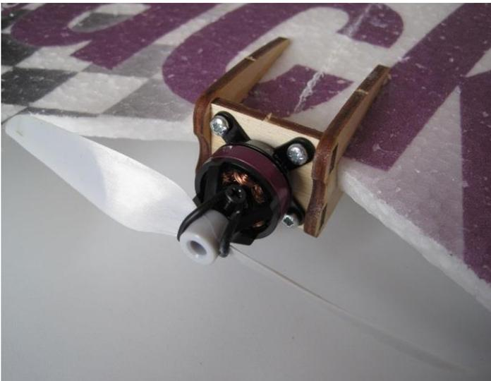
Kleben Sie den Motorhalter mittig an den Flügel. Nun kann bereits der Motor mit den vier beiliegenden Schrauben am Motorspant verschraubt werden. Die Löcher sin bereits passend für unsere Hacker Motoren vorgebohrt.
