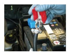
1. CUT THE OLD TERMINAL AND STRIP OFF THE CABLE JACKET APPROXMATELY 20 mm
