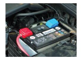
JUST LIFT THE COLOURED COVERS OFF THE BATTERY TERMINAL AND MAKE SURE THE LEVEL IS IN THE CLOSED POSITION
