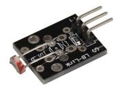
**KY-018** Photoresistor module
