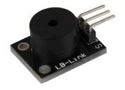
**KY-006** Passiv Piezo-Buzzer module
