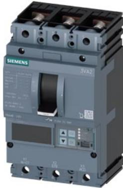
Leistungsschalter 3VA2 IEC Frame 160 Schaltvermögenklasse H Icu=85kA @ 415V 3-polig, Anlagenschutz ETU860, LSIG, In=160A Überlastschutz Ir=63A...160A Kurzschlusschutz Isd=0,6..10x In, li=1,5..10x In N-Leiterschutz optional mit externem Stromwandler, bis 160% Erdschlusschutz, abschaltbar Ig=0,2...1 x In, tg=0,05-0,8s Schraubenflachanschluss
