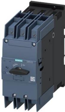
Leistungsschalter Baugröße S3 für den Anlagenschutz mit Approbation circuit-breaker UL 489, CSA C22.2 No.5-02 A-Auslöser 60 A N-Auslöser 780 A Schraubanschluss
