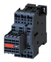
Leistungsschütz, AC-3 12 A, 5,5 kW / 400 V 2 S + 2 Ö, DC 24 V 3-polig, Baugröße S0 Federzuganschluss Hilfsschalter nicht lösbar
