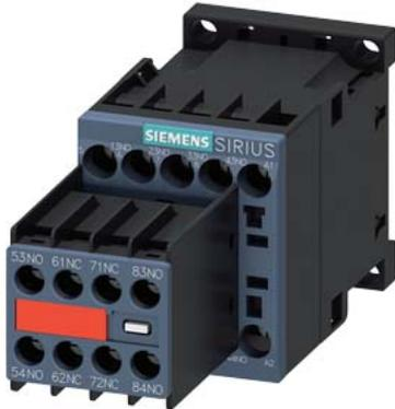
Hilfsschütz, 6 S + 2 Ö, DC 24 V, Baugröße S00, Schraubanschluss, Hilfsschalter unlösbar
