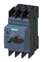
Leistungsschalter Baugröße S0 für den Motorschutz, CLASS 10 A-Auslöser 16...22 A N-Auslöser 286 A Ringkabelschuhanschluss Standardschaltvermögen
