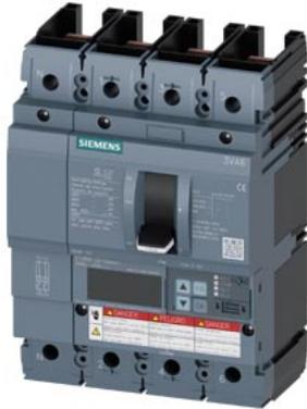
Leistungsschalter 3VA6 UL Frame 150 Schaltvermögenklasse C 100kA @ 480V 4-polig, Anlagenschutz ETU856, LSI, In=100A Überlastschutz, 100% rated Ir=40A...100A Kurzschlusschutz Isd=0,6..10x In, li=1,5..12x In N-Leiterschutz einstellbar (OFF, bis 150%) Erdschlussalarm Meldung über EFB300 o. COM ohne Anschluss
