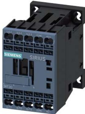
Leistungsschütz, AC-3 12 A, 5,5 kW / 400 V 1 Ö, DC 24 V mit Diode integriert, 3-polig Baugröße S00, Federzuganschluss
