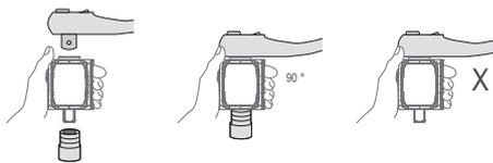
Benutzen Sie nur passende Verlängerungen, Vierkante und Ratschen. Verbinden Sie alle Einzelkomponenten zentriert, gerade und genau fluchtend, ansonsten beschädigen Sie sie.
