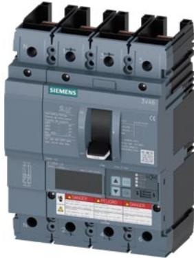
Leistungsschalter 3VA6 UL Frame 150 Schaltvermögenklasse H 65kA @ 480V 4-polig, Anlagenschutz ETU850, LSI, In=150A Überlastschutz, 100% rated Ir=60A...150A Kurzschlusschutz Isd=0,6..10x In, li=1,5..10x In N-Leiterschutz einstellbar (OFF, bis 100%) ohne Anschluss
