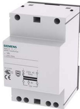
Sicherheitstransformator, 24VA Primär AC 230V, 50Hz, Sekundär 8V, 12V AC mit PTC-Sicherung, 3TE++
