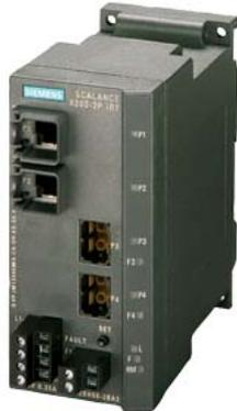
SCALANCE X202-2PIRT managed IE IRT Switch, 2x 10/100 Mbit/s RJ45 Ports, 2x 100 Mbit/s POF SC RJ Ports, Fehlermeldekontakt mit Set- Taster, redundante Spannungs- Versorgung, PROFINET IO Device, Netzwerk- Management, Redundanz-Manager integriert, inkl. elektron. Handbuch auf CD-ROM, C-PLUG optional.
