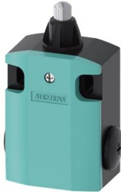
Positionsschalter Metallgehäuse 56 mm breit Geräteanschluss 3x (M20x 1,5) 1S/2Ö Sprungkontakte Kuppenstößel mit Überhub aus Edelstahl
