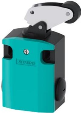
Positionsschalter Metallgehäuse 56 mm breit Geräteanschluss 3x (M20x 1,5) 2S/1Ö Schleikontakte Winkelrollenhebel, Metallhebel und Kunststoffrolle 22 mm
