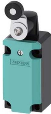
Positionsschalter Kunststoffgehäuse 40 mm Schwenkhebel, nach EN 50041 Geräteanschluss 1 x (M20 x 1,5) 1S/1Ö Schleifkontakte Schwenkantrieb rechts/links einstellbar, Metallhebel 27 mm lang und Kunststoffrolle 19 mm
