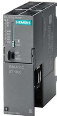
SIMATIC S7-300 CPU 317-2 PN/DP, Zentralbaugruppe mit 1MB Arbeitsspeicher, 1. SS MPI/DP 12MBit/s, 2. SS Ethernet PROFINET, mit 2 Port Switch, Micro Memory Card erforderlich
