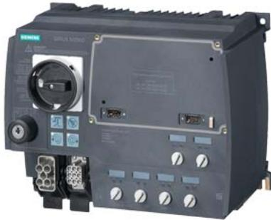
SIRIUS Motorstarter M200D Technologiemodul Direktstarter mechanisch schaltend AC-3, 5,5 kW / 400 V 1,5 A...12,00 A elektronischer Überlastschutz Thermistor: THERMOCLICK / PTC ohne Bremskontakt 4DI / 2DO Han Q4/2 - Han Q8/0 mit Hand-vor-Ort Bedienung und Schlüsselschalter mittels Kommunikationsmodul 3RK1305\* verwendbar an PROFIBUS oder PROFINET
